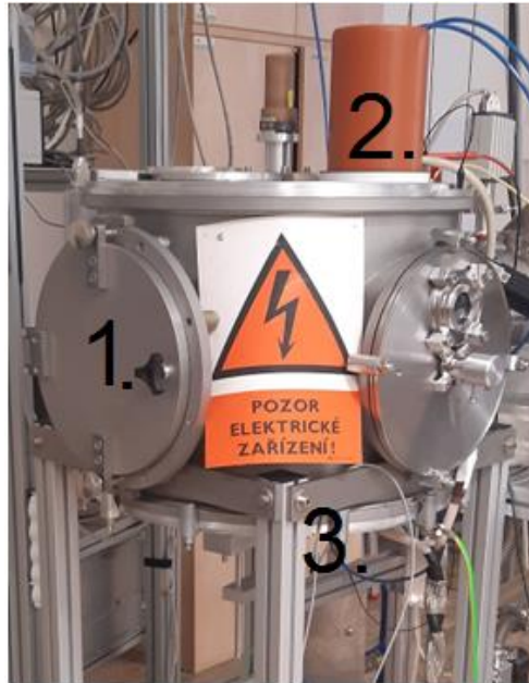
Obr. 4.1. Vakuová komora použitá při deponování tenkých transparentních vodivých oxidů
