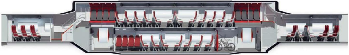
Obrázek 13 – Řez skříní vozu Caravaggio (Hitachi, 2015)
