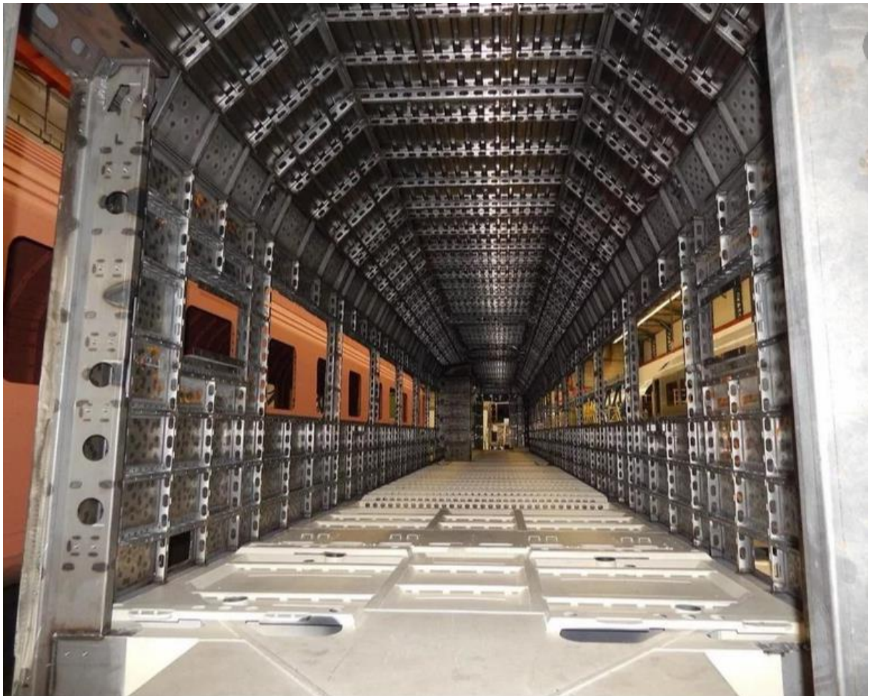
Obrázek 20 Ocelová, svařovaná skříň vozu Railjet (ČD, SIEMENS) s vypálenými odlehčujícími otvory (Šindelář, 2017)
