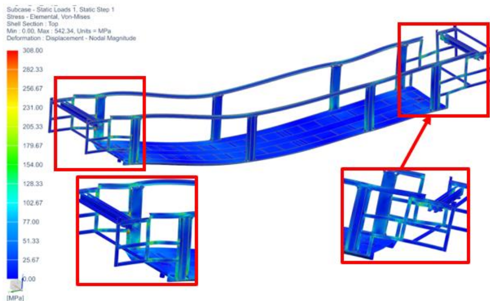
Obrázek 86 - VARIANTA C - Napětí při zatížení vlastní hmotností a užitečné zatížení varianta s nosníkem v podlaze(pouze spodní patro) (Simcenter Nastran)
