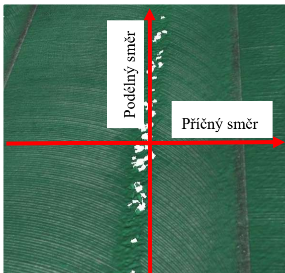
Obrázek 31 - Schéma směrů měření drsnosti drážky 4
