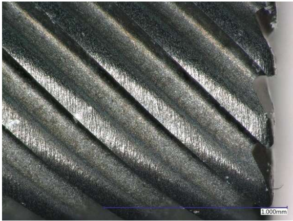
Obrázek 36 - Nástroj 6C Tools před obráběním
