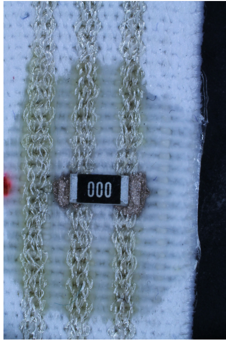
Obr. 3.11: Finální stav spoje s vodivým filamentem.
