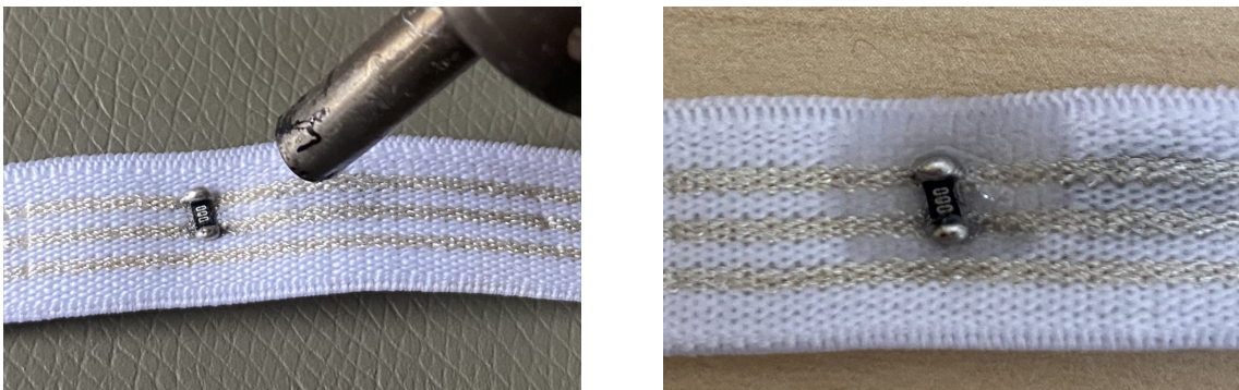
Obr. 3.4: Pájení pomocí horkého vzduchu a zapouzdření nevodivým lepidlem.
