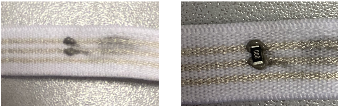
Obr. 3.3: Nanesení pájky a umístění součástky na vodivou stuhu.
