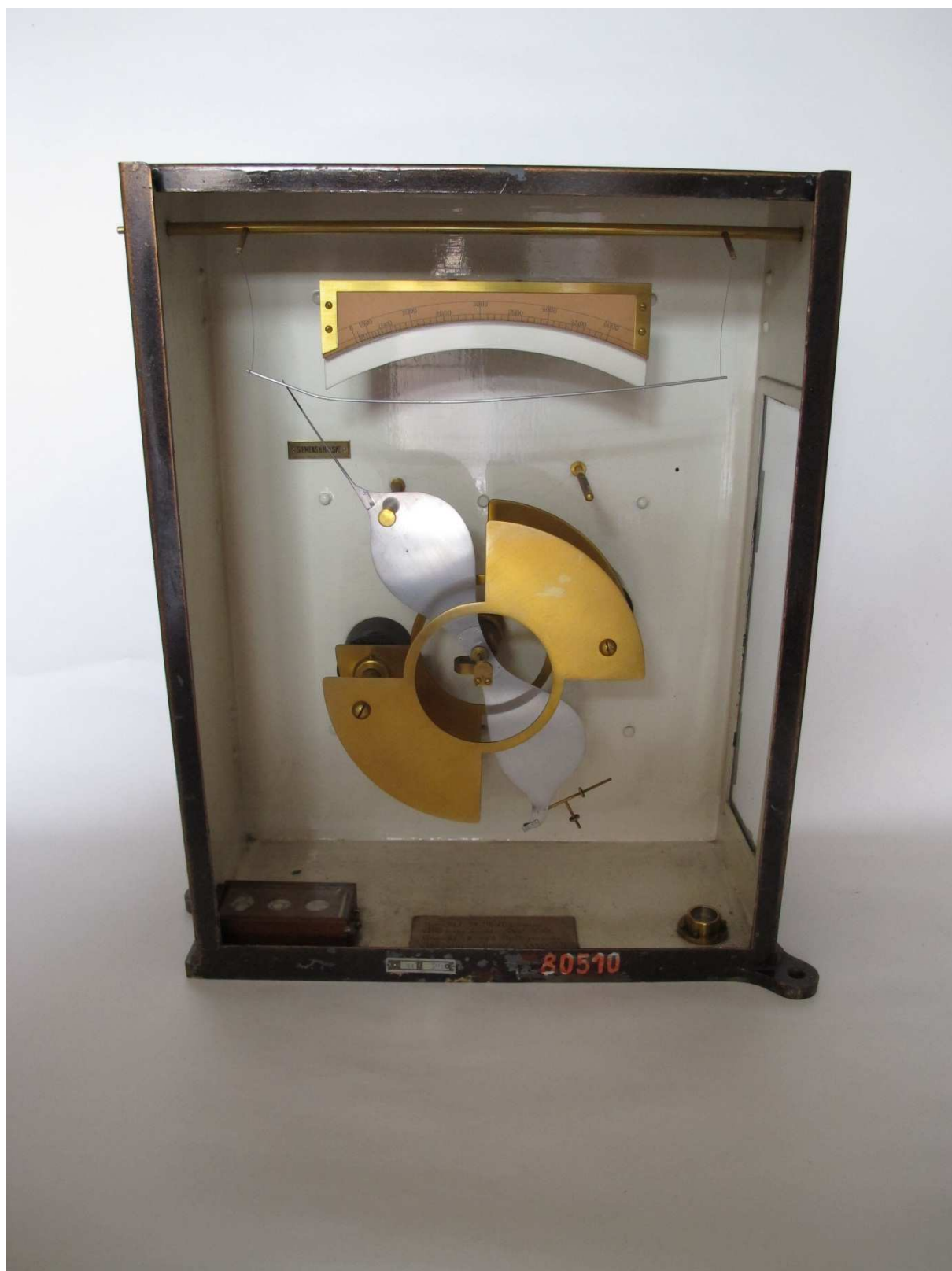
Obrázek 53 – Kvadrantový elektrometr od firmy Siemens & Halske používaný v laboratoři na smíchovské průmyslové škole (viz obrázek číslo 52) 453
