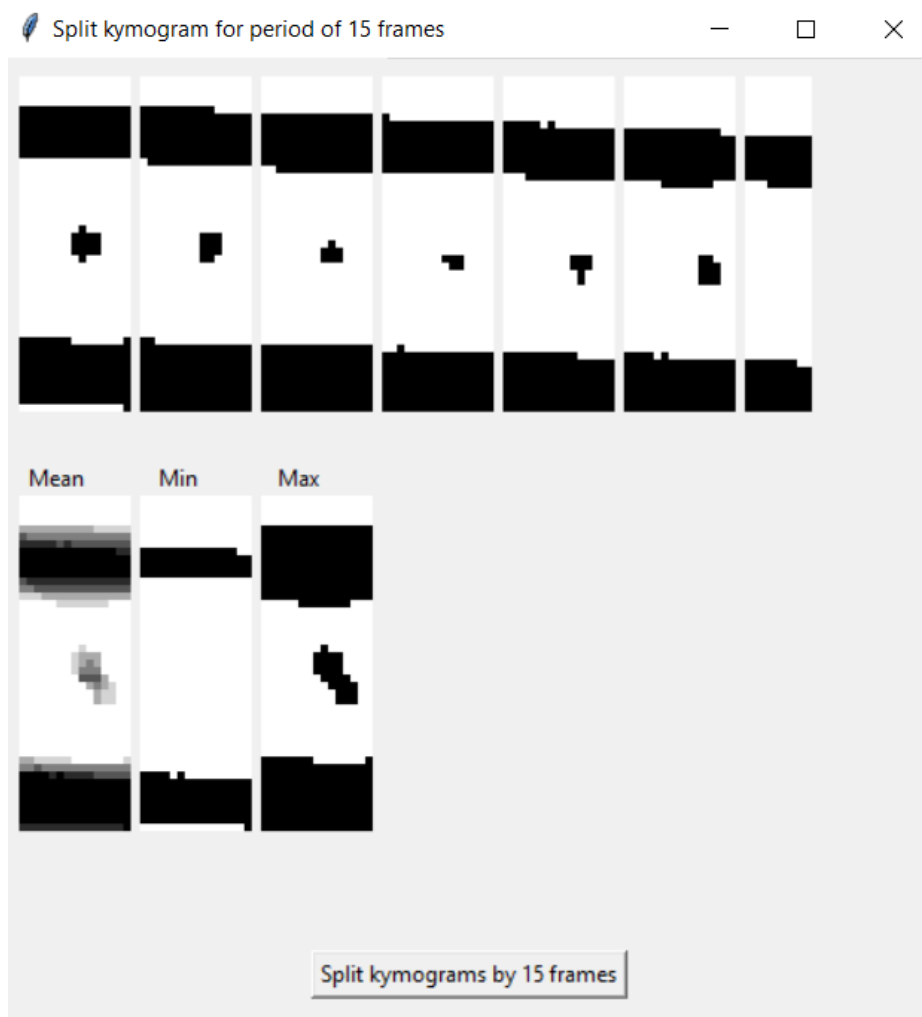
Obrázek 7.4: Okno s výsledkem metod 3, 4 a 7. Lze vidět videokymogram rozdělený pomocí zvolené (resp. vypočtené) periody. Pod ním se nachází průměrný, minimální a maximální snímek vypočtený z jednotlivých snímků.
