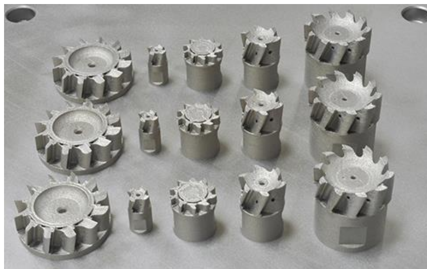
Obr. 4-15 Frézy vyrobené AM společností KOMET GROUP [45]
