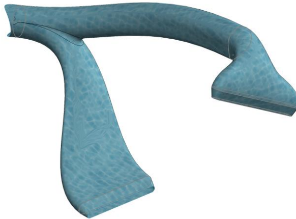
Obr. 6-69 Upravený chladicí kanálek
