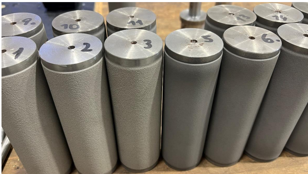
Obr. 6-41 Vzorky HVOF před obráběním
