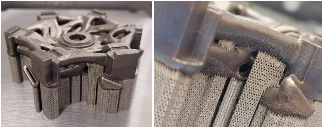
Obr. 6-73 QCA TO 2.0 po vytištění s podporami
