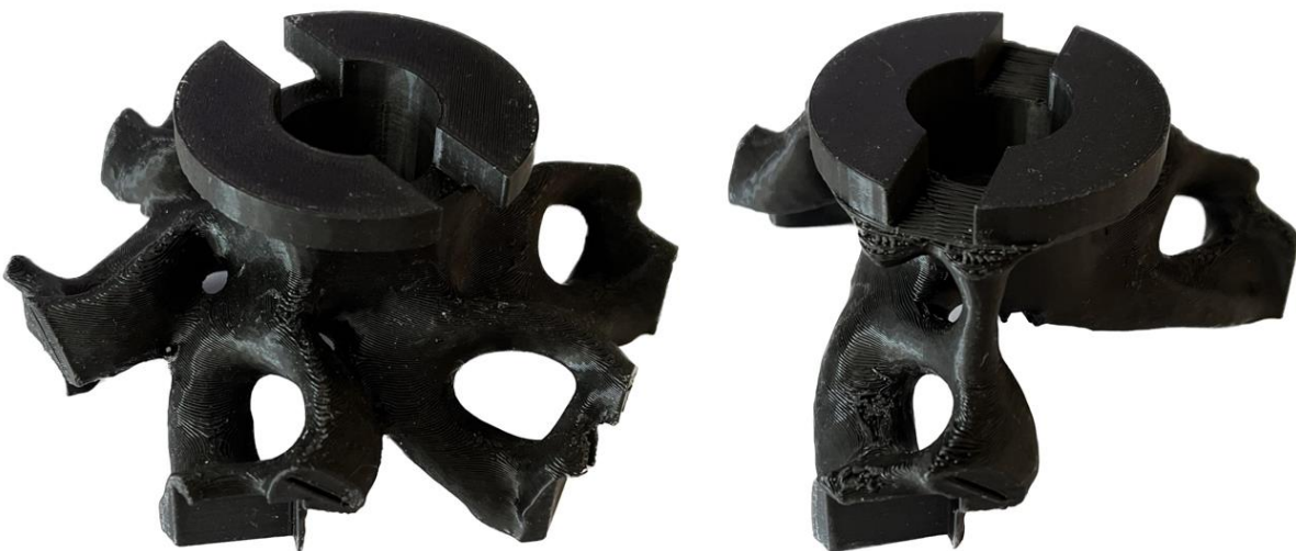
Obr. 6-63 Vytisknutý prototyp ve verzi 3břitého i 6břitého nástroje
