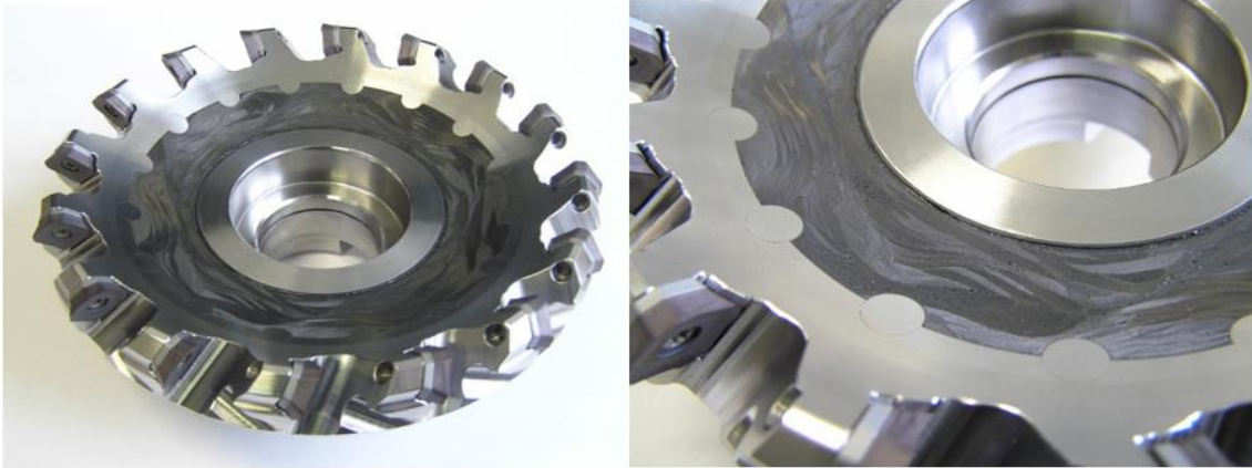
Obr. 4-18 Odlehčená frézovací hlava s tělem z kompozitu [47]
