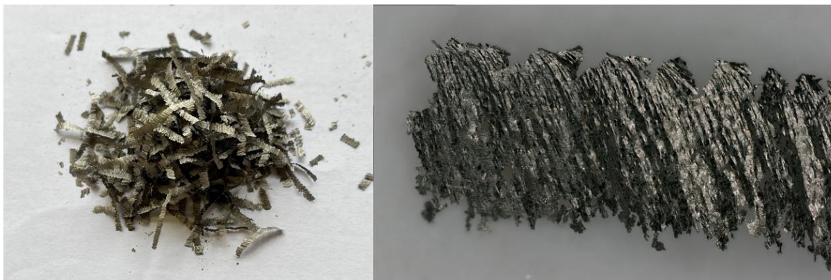
Obr. 6-15 Třísky vzniklé při obrábění nástřiku NiCrBSi
