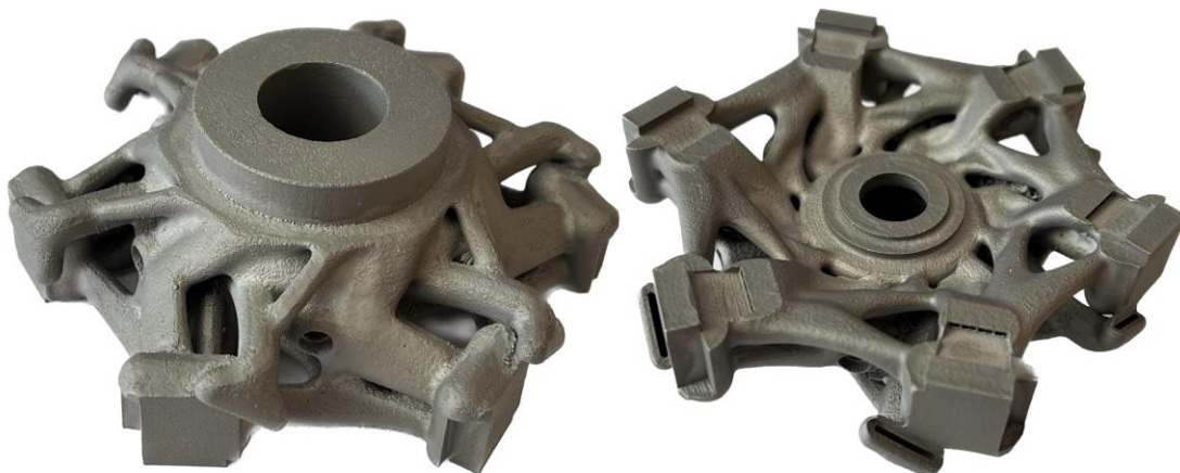
Obr. 6-73 QCA TO 2.0 po vytištění s podporami
