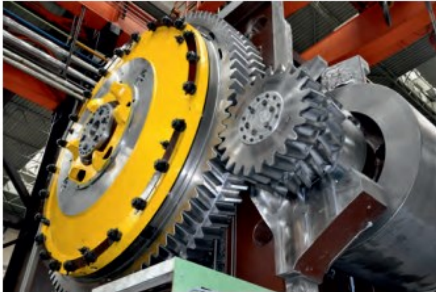
Obrázek 54 - Pohled na ozubené soukolí lisu LMZ 2500 (setrvačnick na hřídeli za pastorkem; žluté kolo je víko spojky)
