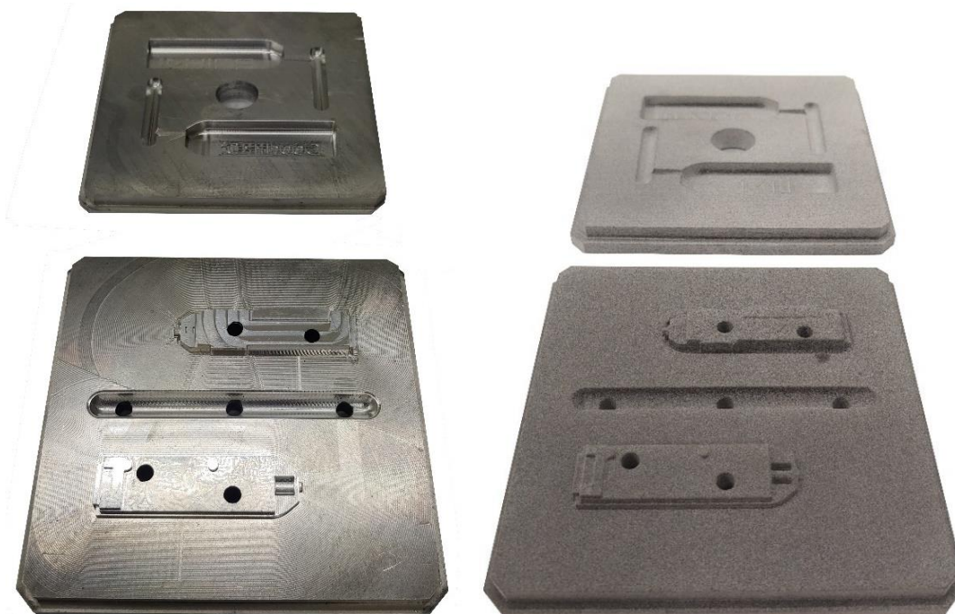
Obr. 31 – Porovnání hliníkové vložky s plastovou vložkou pro vstřikování testovacího dílu
