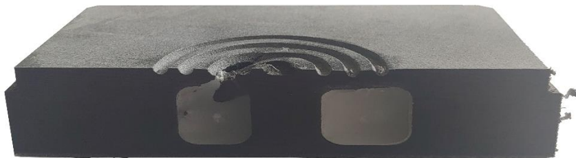
Obr. 46 – Pokus chladit plastovou vložku kanálkem
