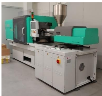
Obr. 27 – Vstřikovací lis 470 E 1000-290 G včetně základních parametrů [25]
