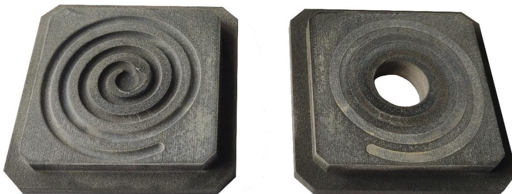
Obr. 8 – Vstřikovací vložky z HP PA 12 GB po testování vrstvy PTFE
