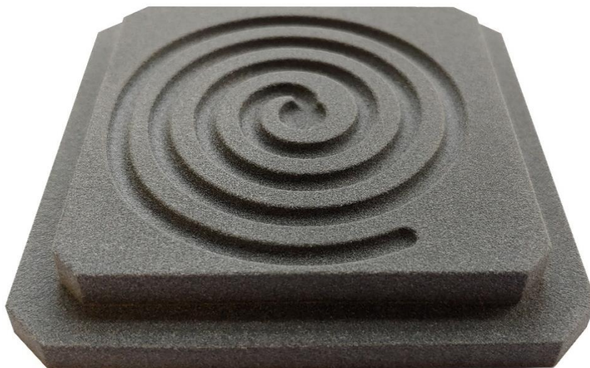
Obr. 1 – Pohyblivá vložka z HP PA 12 GB pro zkoušku zatékavosti
