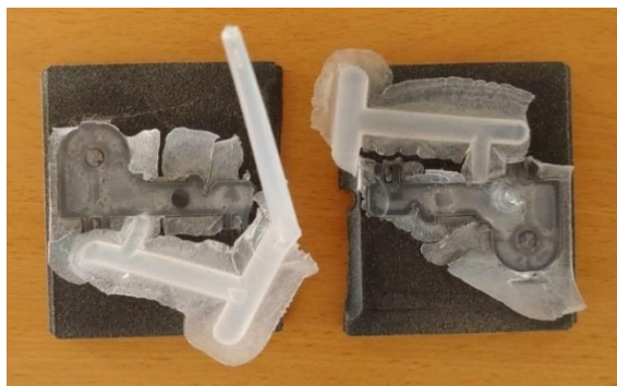
Obr. 56 – Důsledek příliš dlouhé doby chlazení
