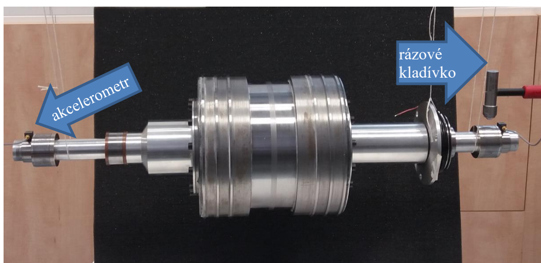
Obrázek 4-15: Experimentální modální analýza s rázovým kladívkem
