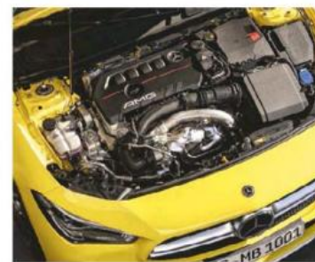
▲ Бензиновый 2,0-литровый мотор нового спортивного седана развивает 306 л.с. и 400 Nm крутящего момента при 2000 об/мин. Автомобиль оснащен рублевой трансмиссией с переменным передаточным отношением и выхлопом AMG
