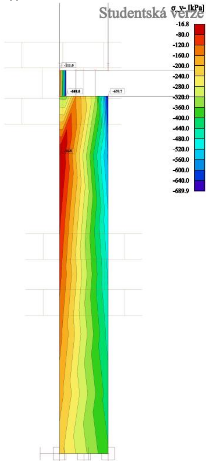
Obrázek č. 182: Ukázka finálního modelu – zdicí materiál s nižší objemovou pevností; prefabrikované panely – výsledné napětí \sigma_y – stěna v nejnižším podlaží. [1]
