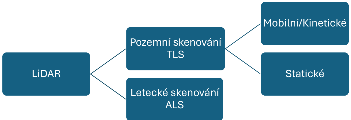
Obrázek 4: Grafické rozdělení laserového skenování [autor, 2024]
