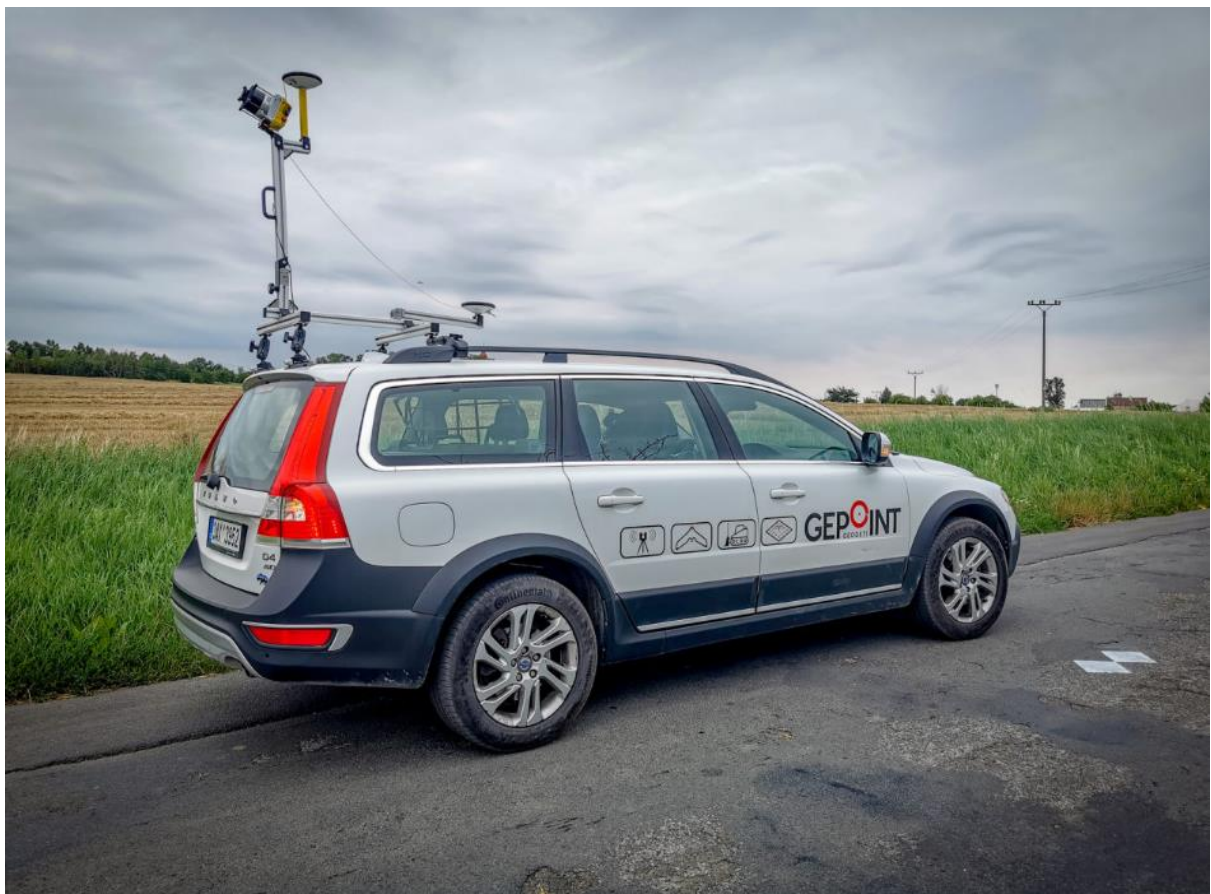
Obrázek 6: Příklad mobilního skenování – GEPOINT [16]
