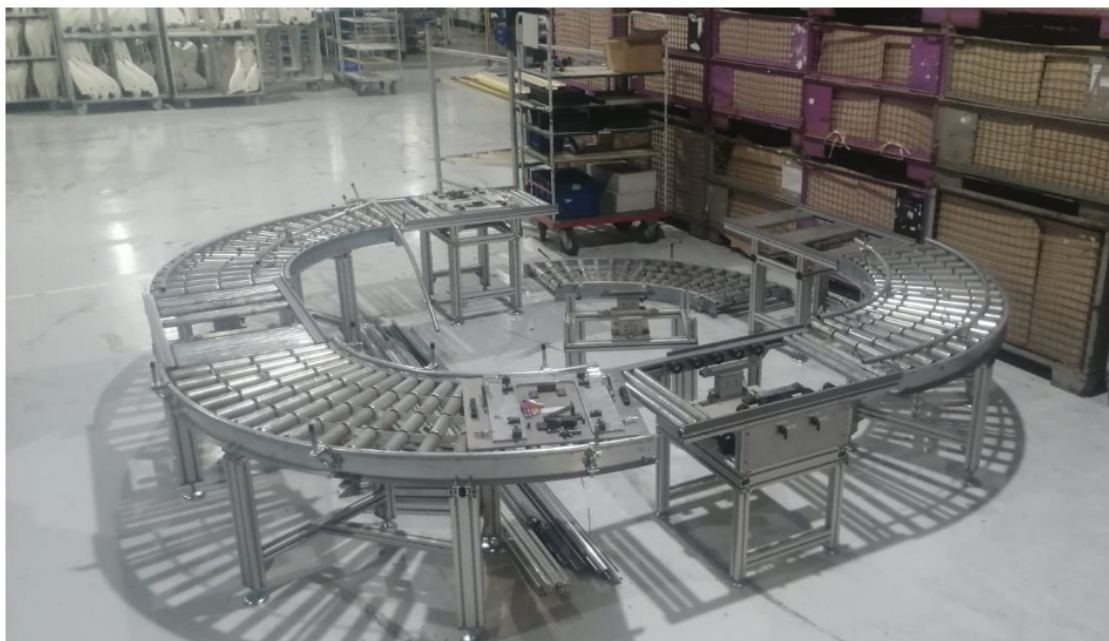
Obr. č. 20: Testovací konzolová linka – možnost/návrh č. 2
