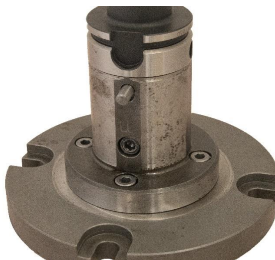
Obr. 19 Současný stav přípravku detail na ovládní vačky
