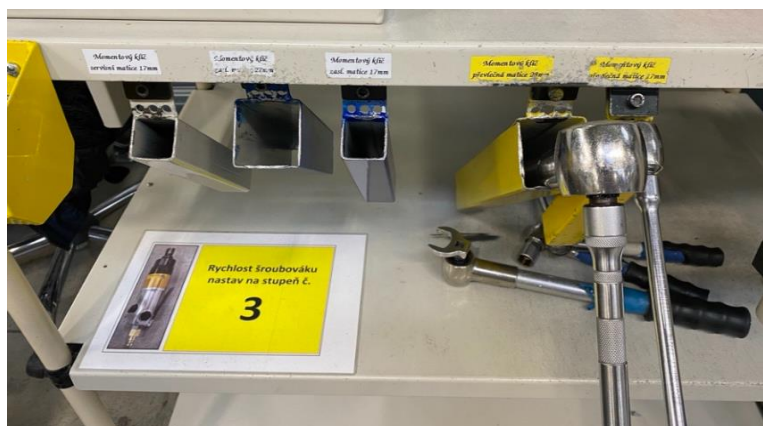
Obr. 25: Nevhodně odložené nářadí
