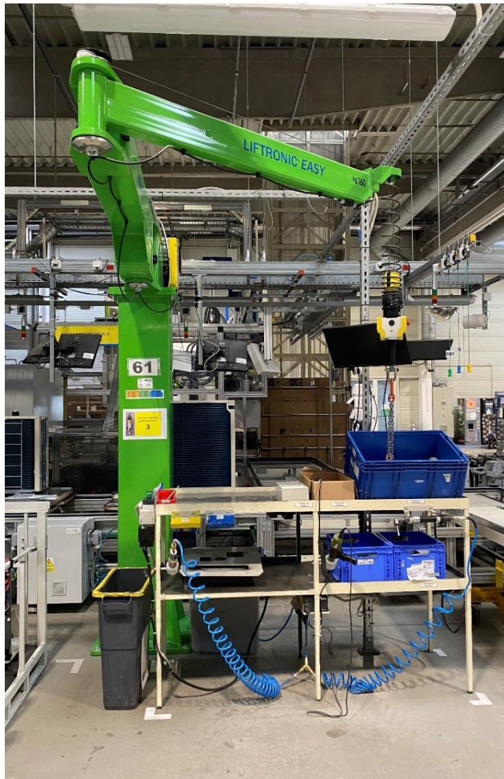
Obr. 20: Manipulátor pro přesun hydrokitu na vozík
