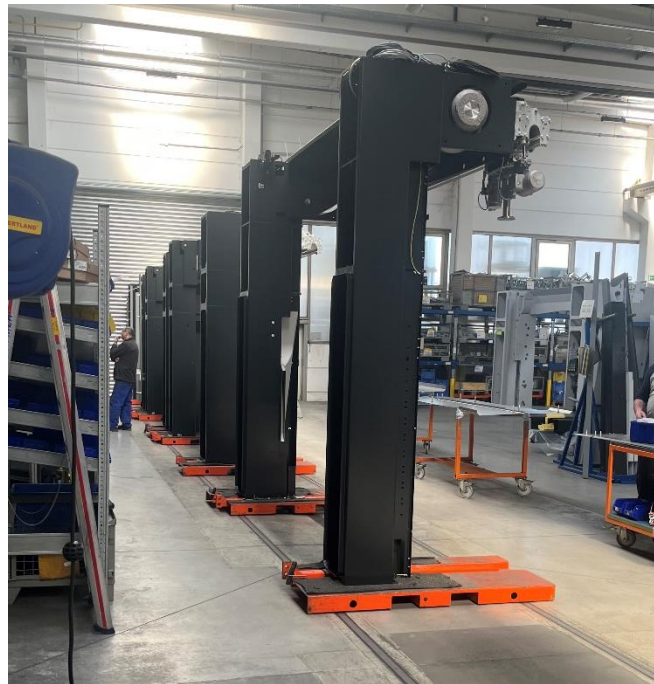
Obrázek 17 - Hlavní konstrukce portálu
