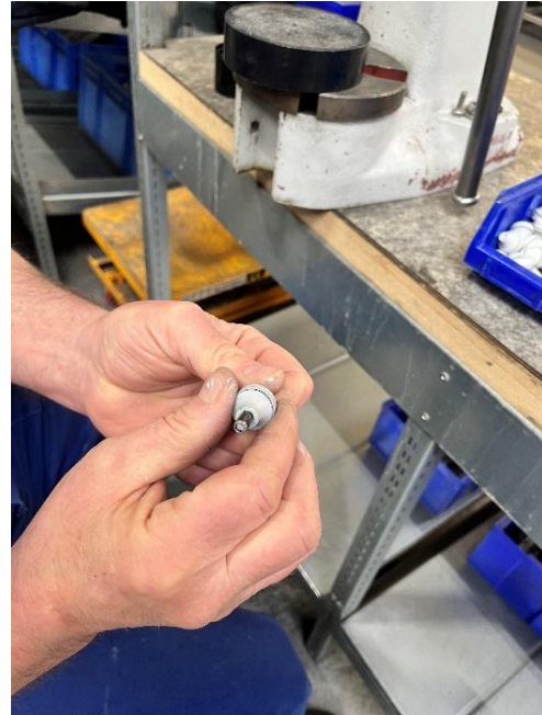
Obrázek 35 - Vytvořená díra v průchodce
