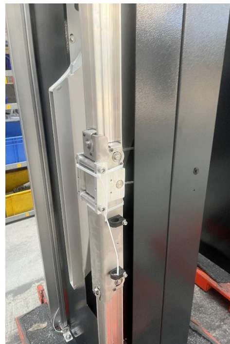
Obrázek 18 - Kolejnice a vedení pro střešní sušení
