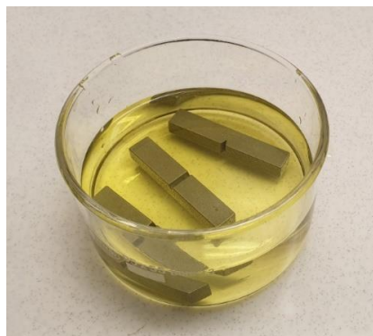
Obr. 15 Ponorná metoda navodíkování
