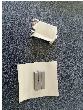
Obr. 18 Zkušební vzorky zabalené do fólie proti oduhličení
