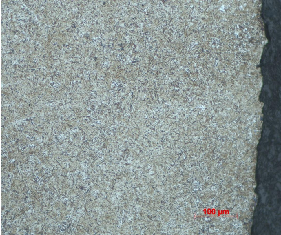
Obr.XIII – Mikrostruktura vzorku kaleného v 10% polymerním roztoku při pokojové teplotě zvětšená 200x – oblast 1
