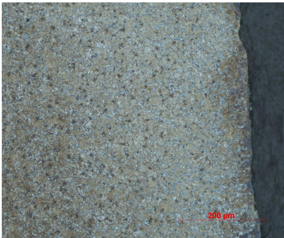
Obr.XLIII – Mikrostruktura vzorku kaleného v 15% polymerním roztoku při 40°C zvětšená 200x – oblast 1
