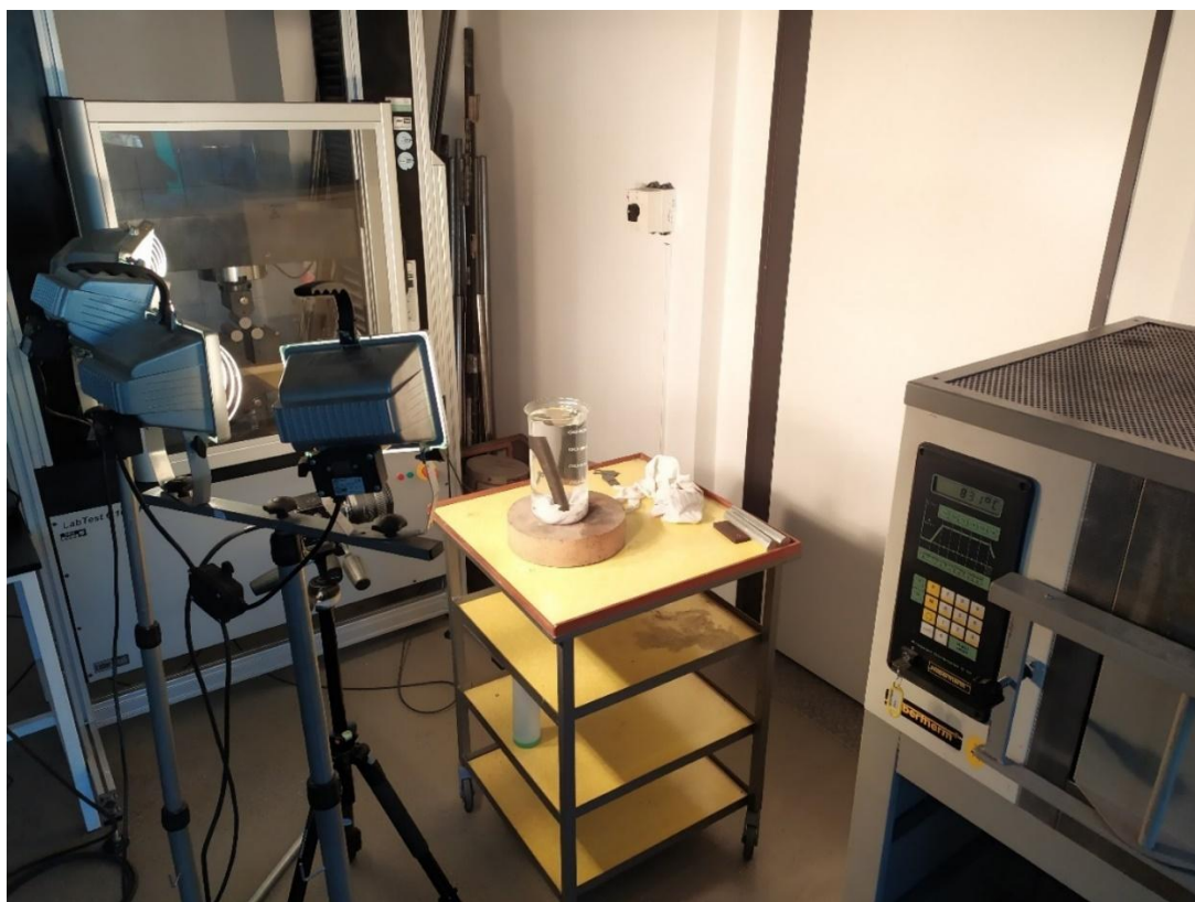
Obr.54 – Pracoviště záznamu povrchových jevů, dva osvětlovače namířené lehce nad snímané místo pro minimalizaci odlesků, vysokorychlostní kamera namířená na střed baňky a stůl s baňkou vedle používané pece pro co nejrychlejší přesun vzorku z pece do chladicího média
