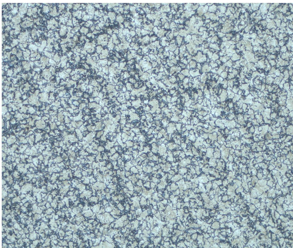
Obr.L – Mikrostruktura vzorku kaleného ve vodě při 60°C 200x – oblast 2
