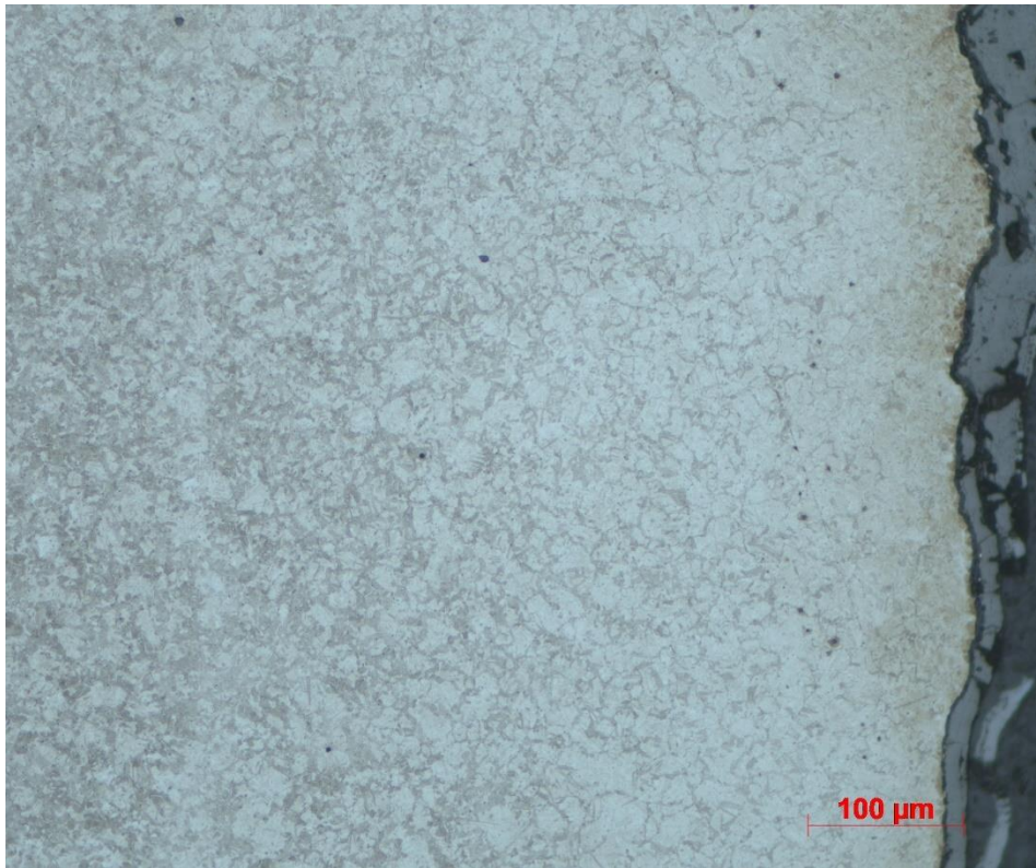
Obr.LV – Mikrostruktura vzorku kaleného v 5% polymerním roztoku při 60°C zvětšená 200x – oblast 1
