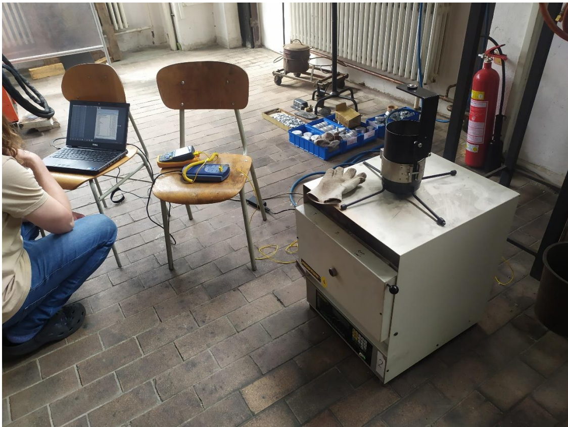
Obr.81 – Pracoviště měření ochlazovacích křivek pomocí quench testu
