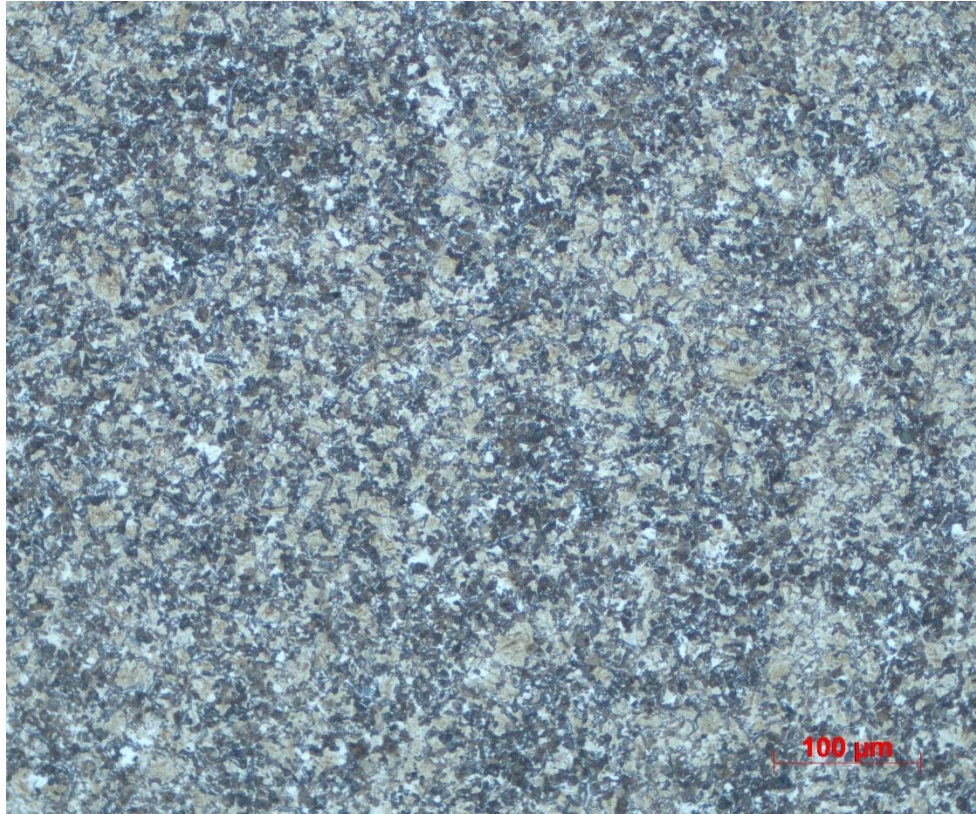
Obr.XV – Mikrostruktura vzorku kaleného v 10% polymerním roztoku při pokojové teplotě zvětšená 200x – oblast 3
