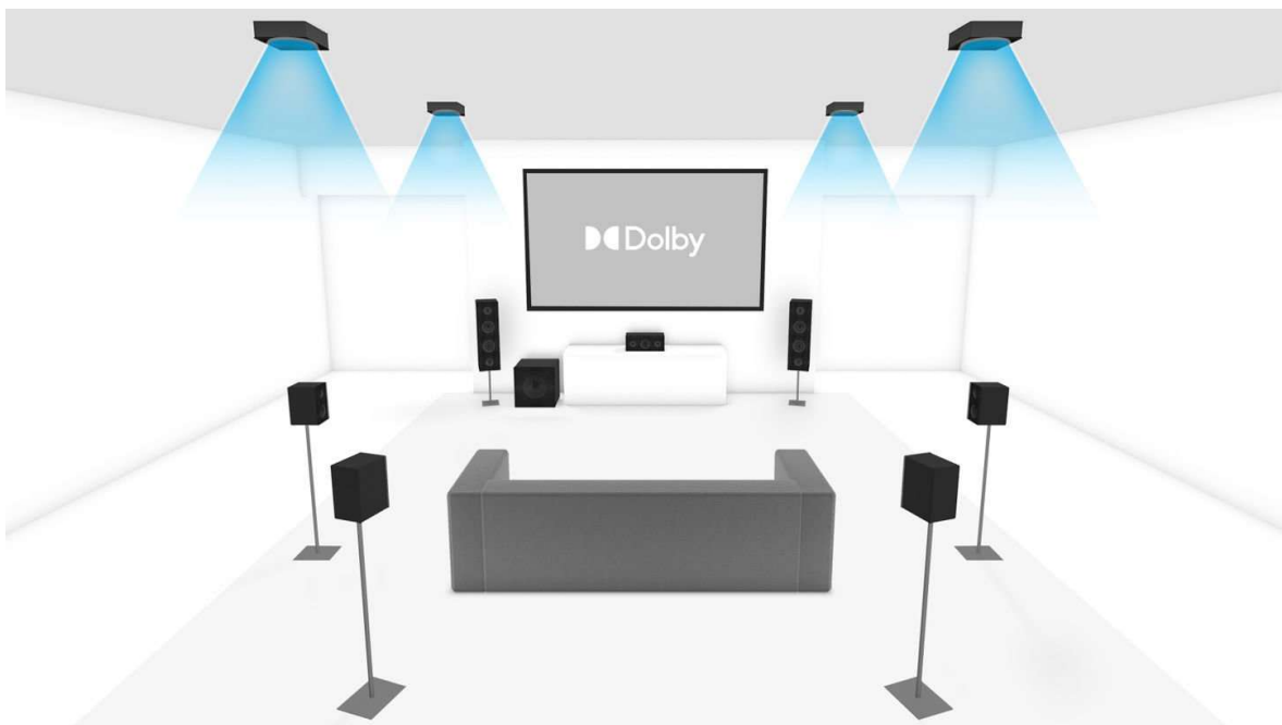
Obr. 8: Pohled na rozmístění reproduktorů v systému 7.1.4. Převzato z [31]
