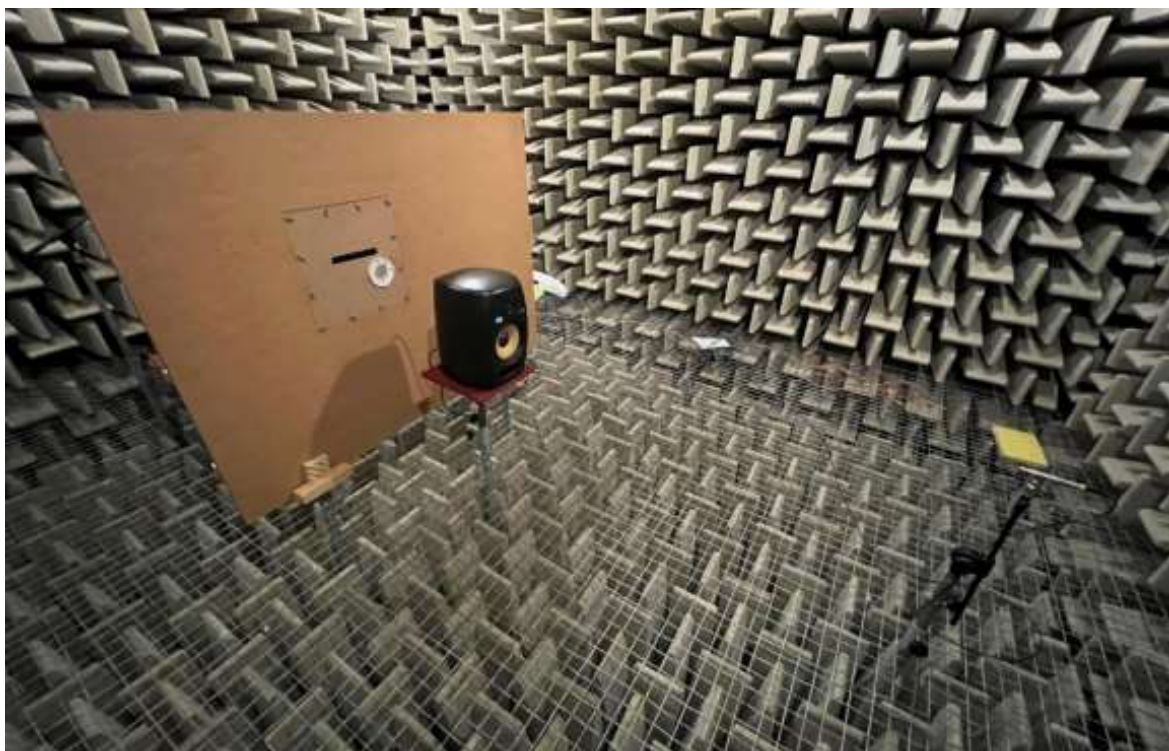
Obr. 25: Měření vlivu odrazivé plochy za reproduktorem v bezodrazové komoře. Převzato z [28]
