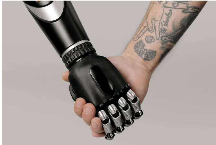
Obrázek 23 - protetická náhrada ruky využívající karbonová vlákna [27]
