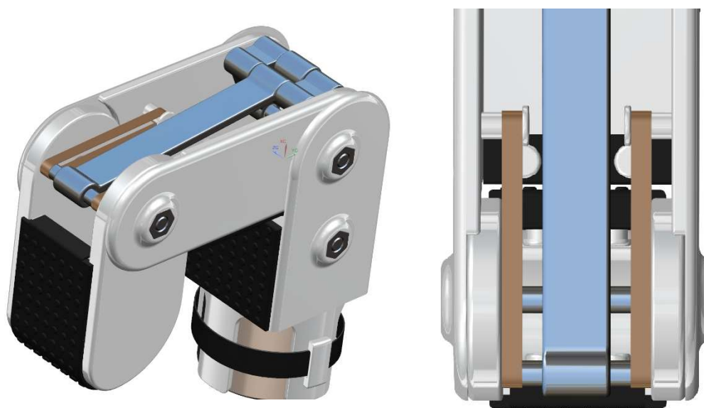
Obrázek 43 - Konstrukční řešení vratného pohybu pomocí gumiček
