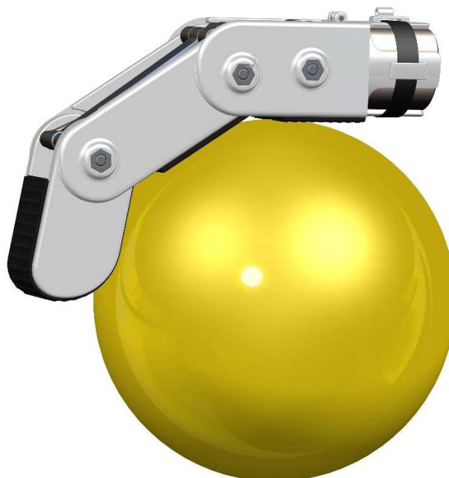
Obrázek 54 - Simulace úchopu tenisového míčku (65 mm)
