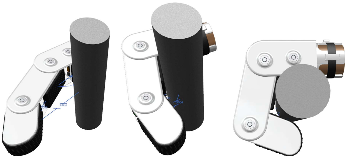
Obrázek 49 - Simulace palmárního úchopu pro průměr 15 mm
