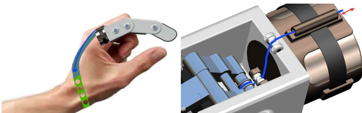
Obrázek 40 - Schématicky znázorněný mechanismus pro upevnění a aktivaci prstu
