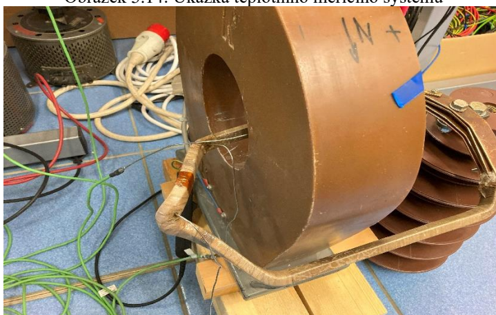
Obrázek 5.15: Ukázka umístění vzorku v transformátoru a umístění teplotních senzorů
