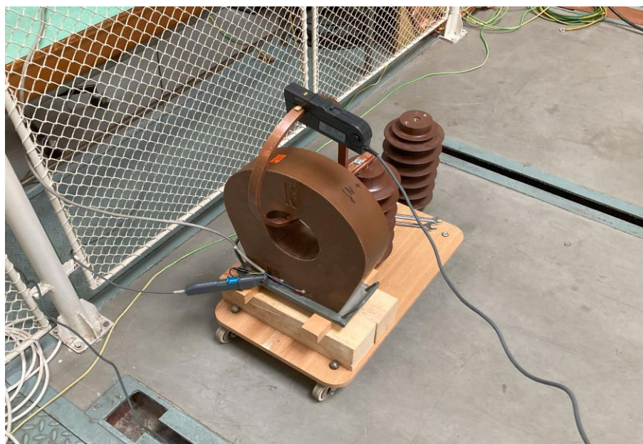
Obrázek 5.3: Část sestavy pro tvorbu kalibračních křivek – proudové měřící kleště
