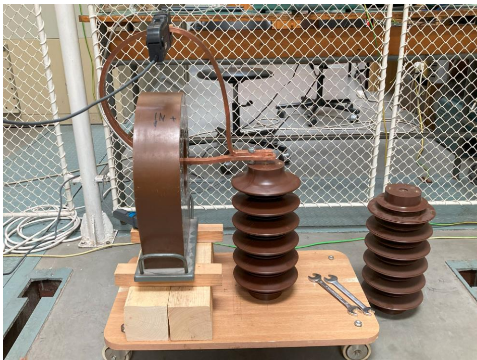
Obrázek 5.4: Část sestavy pro měření kalibračních křivek – umístění vzorku na izolátoru
