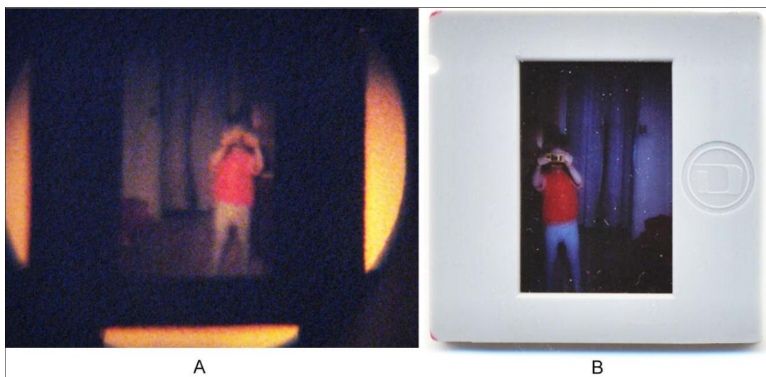
Obrázek 55: V levé části promítaný obraz na stínítku, v pravé části původní diapozitiv. [autor]
