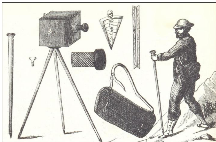
Obrázek 33: Fotoaparát rozložený a složený s praktickou ukázkou nošení, rok 1878. [81]
