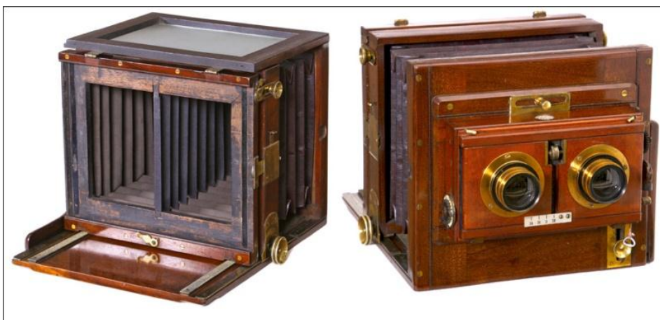
Obrázek 18: Stereoskopický fotografický přístroj. [37]
