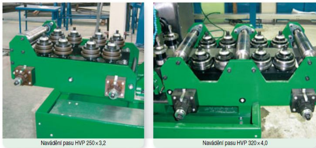
Obrázek 4.4: Navádění pásu v profilovací sekci, [14]
