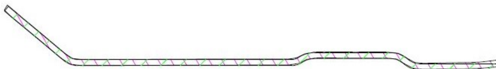
Obrázek 9.4: Porovnání reálné geometrie třetího pořadí ze simulace s požadovanou
