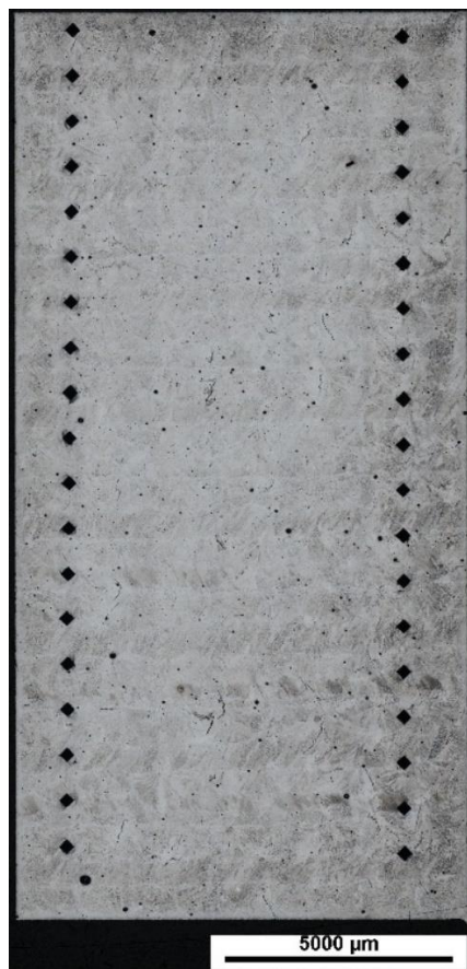
Obrázek 25 Soulep v naleptaném stavu
