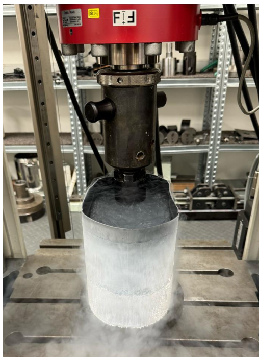
Obrázek 34 Tahová zkouška v kapalném dusíku
