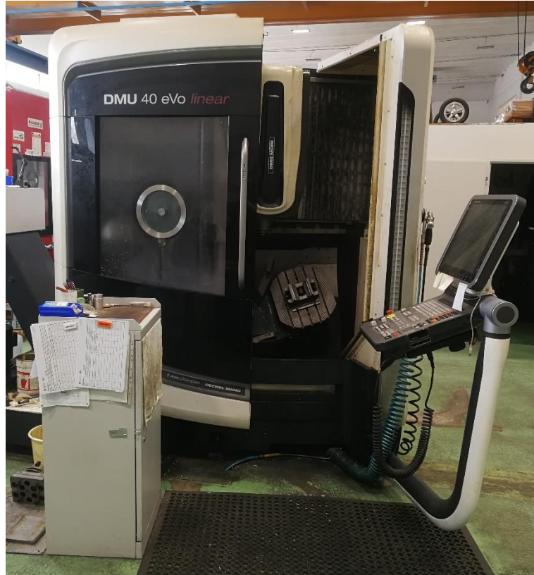
Obr. 71: pětiosé obráběcí centrum DMU eVo linear DMG MORI
