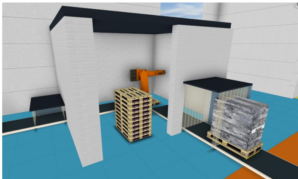
Obr. 56: Vizualizace průchodu dopravníků a umístění lamelových clon
