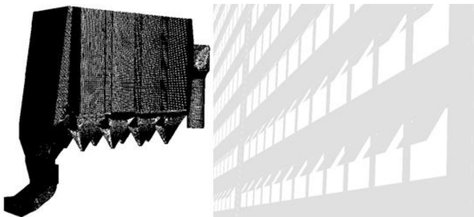
Obrázek 7 Geometrie filtru (vlevo), geometrie rozdělovací stěny s klapkami (vpravo)
