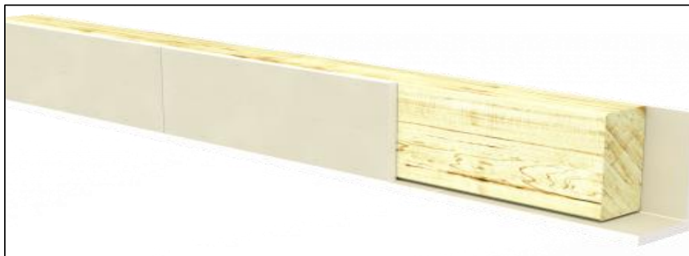
Obrázek 5: Požární obklad dřevěného nosníku, [15]
