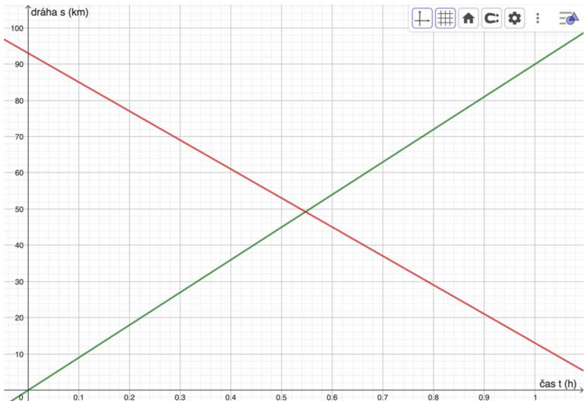
Obrázek 4: Grafické znázornění závislosti dráhy na čase obou vozidel při pohybu proti sobě
