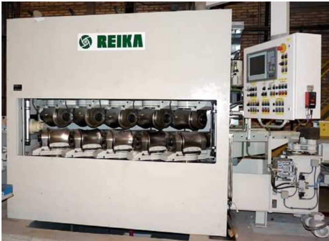
Obr. 7 Deseti-rolnová rovnačka pro rovnání trubek
