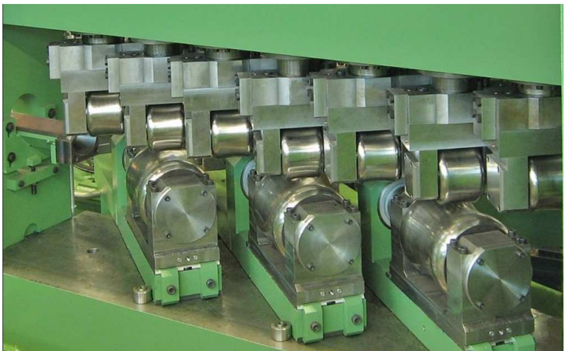
Obr. 4 Deseti-rolnová rovnačka s rolnami různé velikosti
