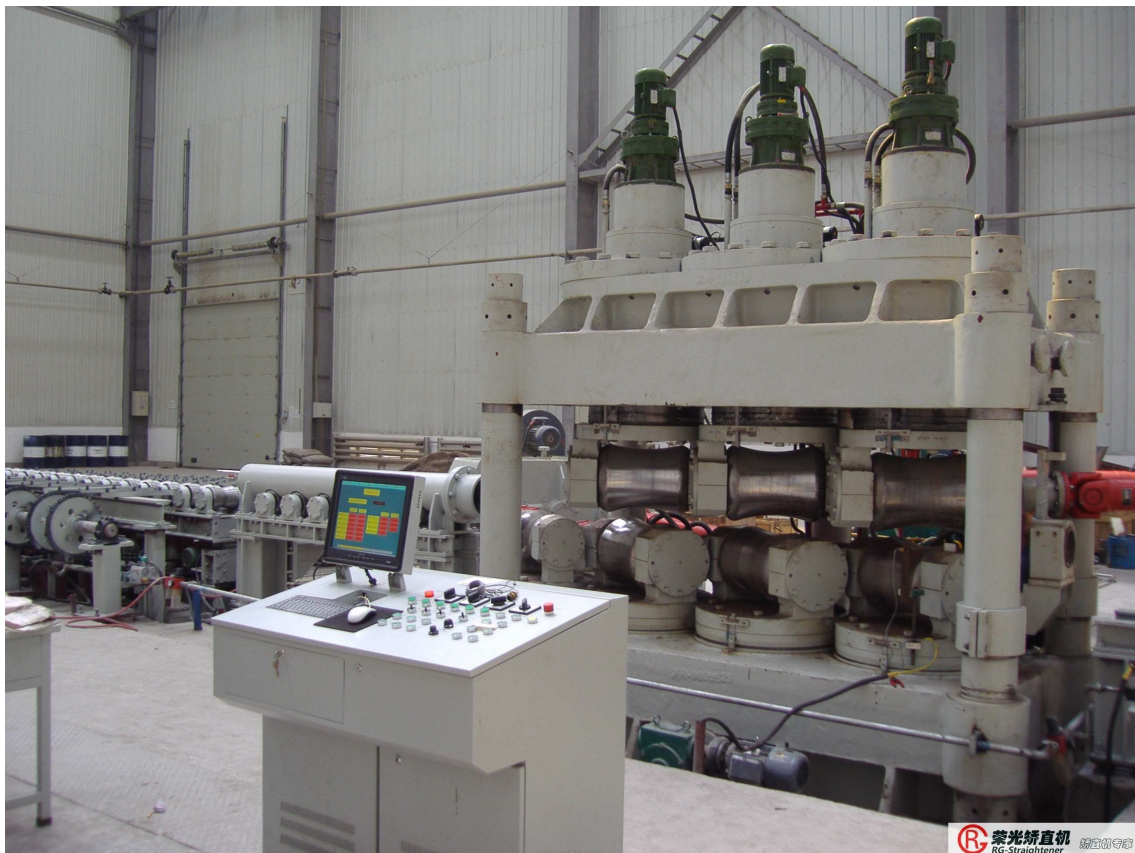
Obr. 1 Multi-rolnová rovnačka s ovládacím panelem operátora a příslušenstvím
