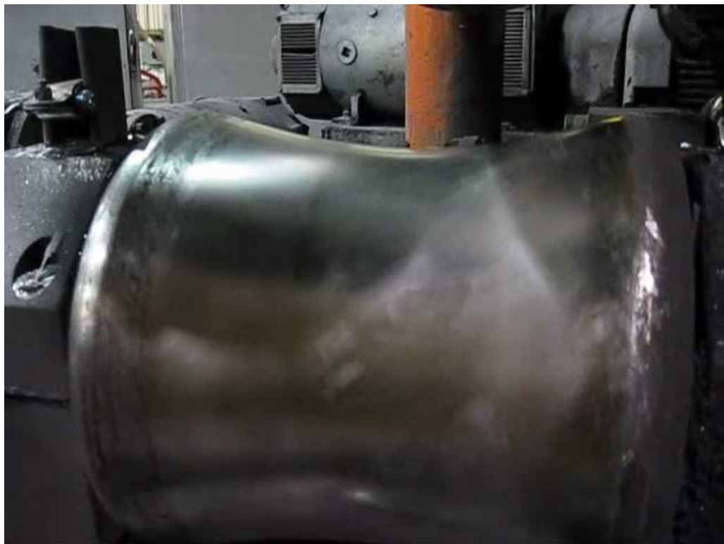
Obr. 30 Ukázka opotřebení zejména střední části rolen při procesu rovnání
