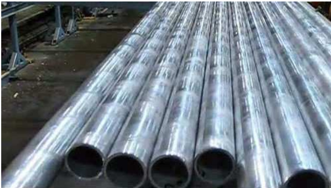
Obr. 10 Spirálovitě zdeformované plochy na povrchu rovnaných trubek
