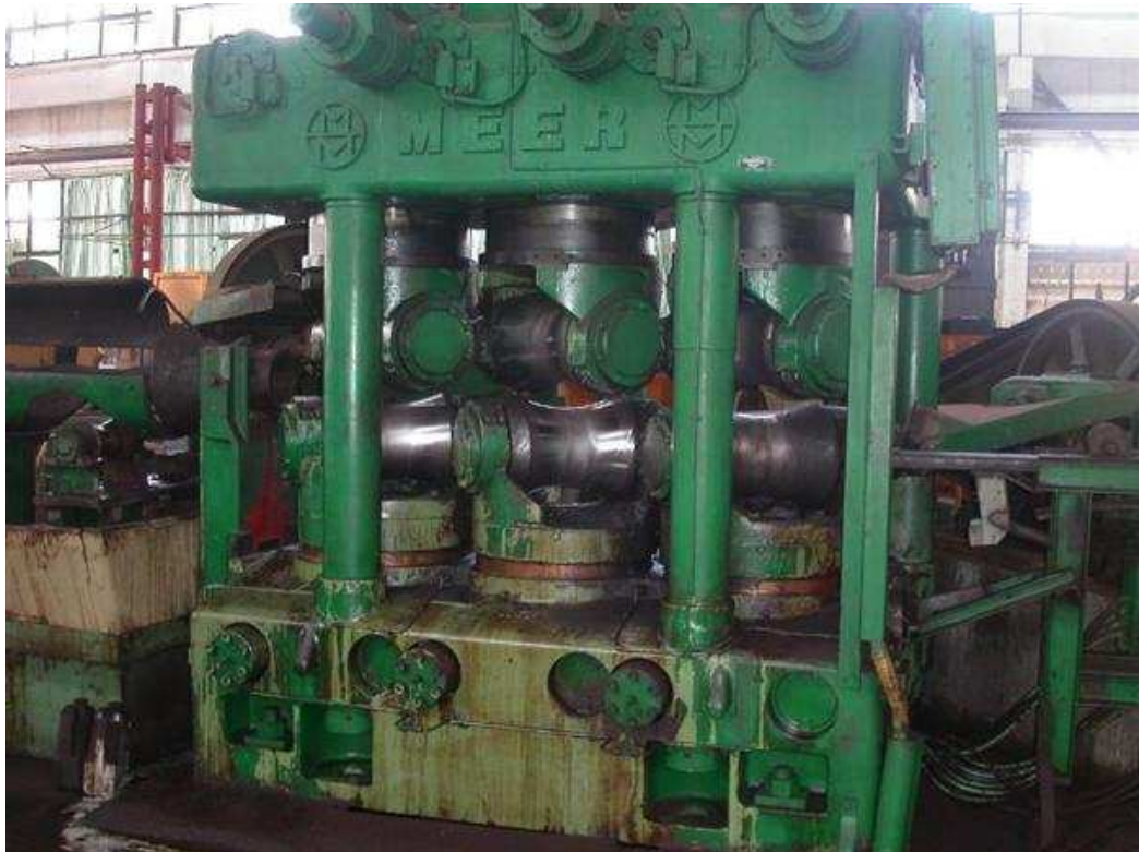
Obr. 6 Šesti-rolnová rovnačka pro rovnání silnostěnných trubek
