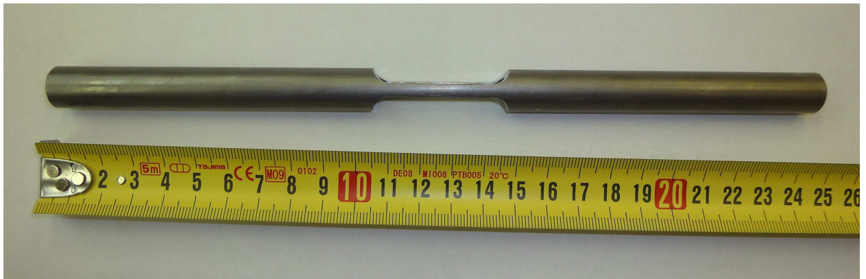
Obr. 37 Testovací vzorek trubky s vyfrézovaným vrubem
