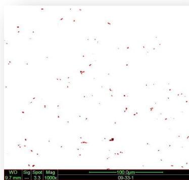
Obr. 4.2.2.2 Povlak WC-Cr 3 C 2 -Ni, parametry # 1, SEM, Mix BSE+SE, zv. 1000× vpravo rozložení a obsah pórů pro mikrostrukturu vlevo
