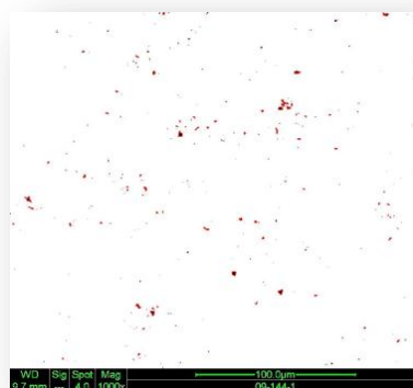
Obr. 4.2.2.5 Povlak WC-Cr 3 C 2 -Ni, parametry # 2, SEM, Mix BSE+SE, zv. 1000× vpravo rozložení a obsah pórů pro mikrostrukturu vlevo
