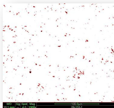
Obr. 4.2.2.14 Povlak WC-Cr 3 C 2 -Ni, parametry # 5, SEM, Mix BSE+SE, zv. 1000×, vpravo rozložení a obsah pórů pro mikrostrukturu vlevo
