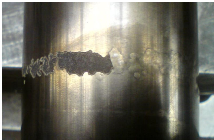
Obr. 2.1 Celkový pohled na charakter poškození povlaku na vřetenu
