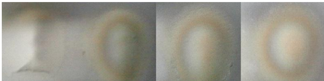
Obr. 4.4.2.1 Výsledné stopy při optimalizaci průtoku nosného plynu, zleva doprava průtoky Ar 14 l/min, 12 l/min, 10 l/min a 8 l/min
