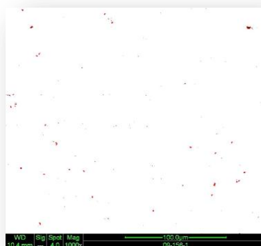
Obr. 4.2.2.17 Povlak WC-Cr 3 C 2 -Ni, parametry # 6, SEM, Mix BSE+SE, zv. 1000× , vpravo rozložení a obsah pórů pro mikrostrukturu vlevo
