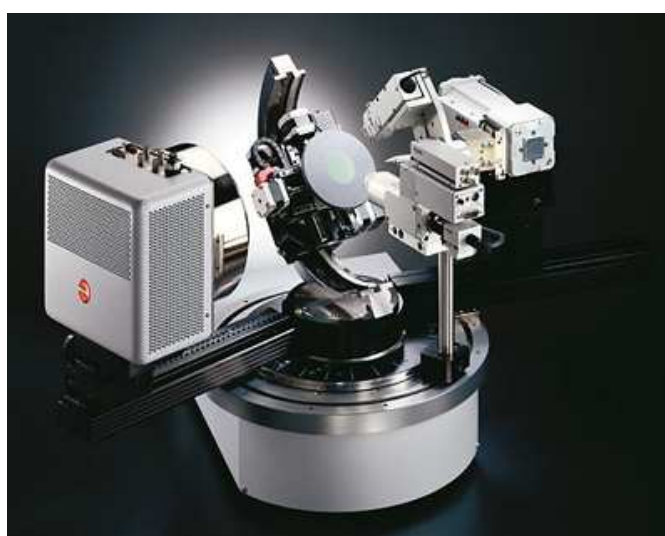
Obr. 46.: Detail goniometru jakým je vybaven i přístroj ve Výzkumném centru – Nové technologie, vlevo na rameni detektor HI-STAR
