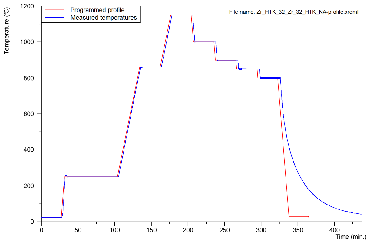
Obr. 117.: Naprogramovaný a skutečný průběh ohřevu a ochlazování vzorku Zr_32
