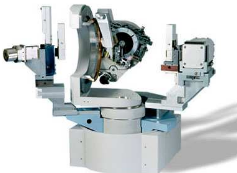
Obr. 38.: Goniometr přístroje Panalytical X'Pert Pro v horizontálním osazení.
