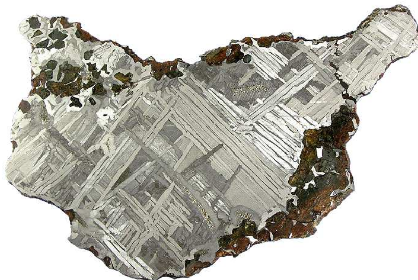
Obr. 15.: Typická Widmannstättenova struktura pozorovaná v železném meteoritu
