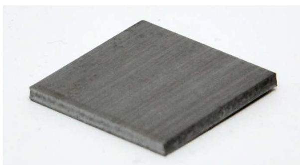
Obr. 36.: Vzorek z čistého Zr dodaný firmou Goodfellow Ltd.
