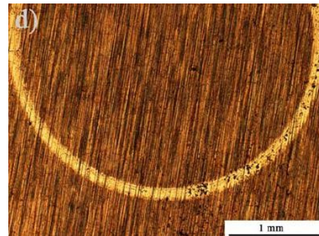
Obr. 47: Stopa tribologického opotřebení při použití maziva po zkoušce BCr povlaku [53]
