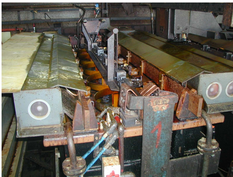
Obr. 17: Chromovací vana pro písní kroužky (Buzuluk a.s.)
