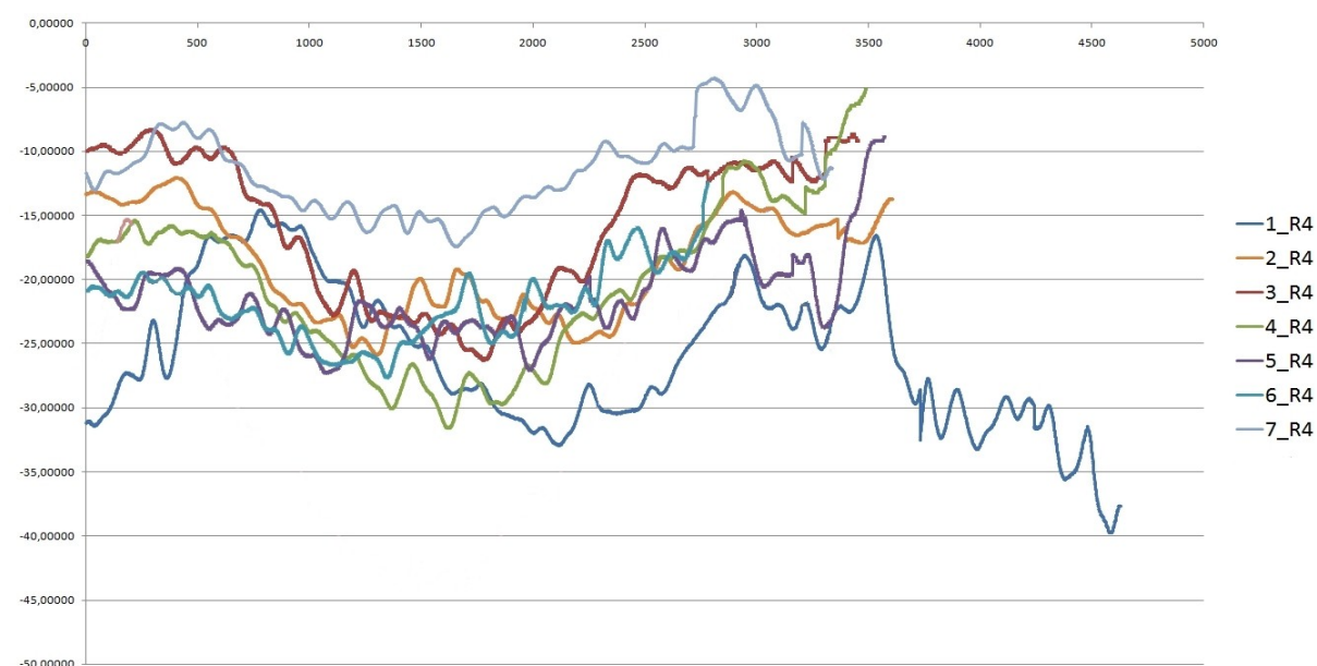
Obr. 104: Profily jednotlivých tribologických stop, test 2, kulička Al_2O_3
