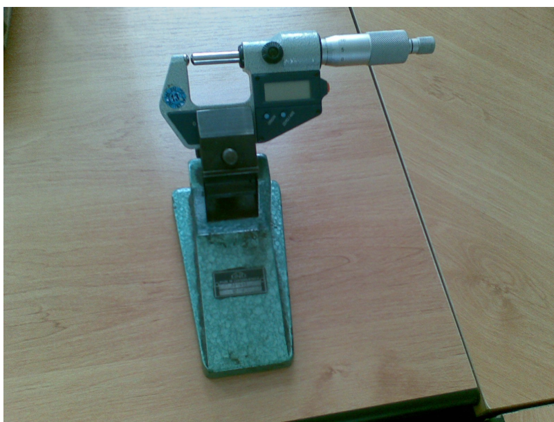
Obr. 142: Mikrometr, kterým byla měřena radiální tloušťka pístních kroužků
