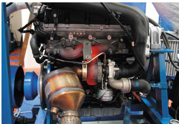
Obr. 49: Upevnění motoru na dynamometru (Buzuluk a.s.)
