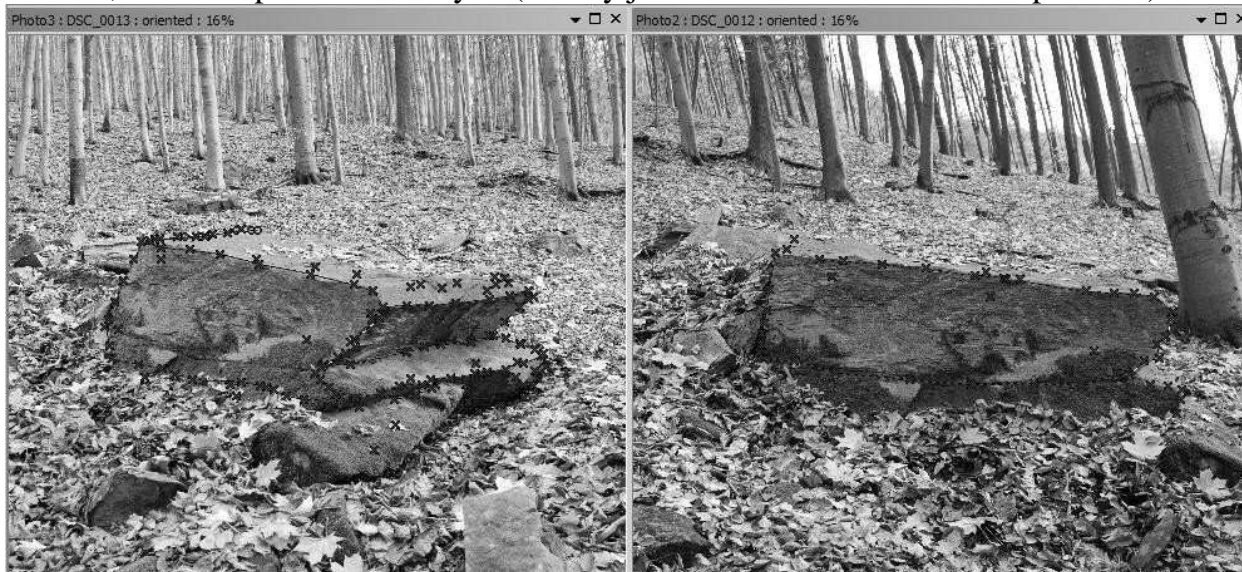
Obr. 2 Referencování snímků pomocí identických bodů
