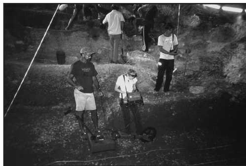
Obrázek 5. Aplikace GPR na lokalitě s cílem identifikovat hloubku skalního podloží. Zleva L. Conyers a K. Elliott.
