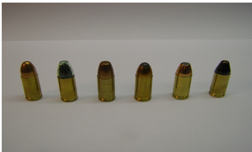
obr. č 1: zleva: SB 9mm Luger FMJ, Police 7,5g.; Libra 9mm L brokový, Magtech 9mmL Subsonik; SaB 9mm L poloplášť, Magtech JSP Flat 9mmL, Fiocchi 9mm L Black Mamba; foto archiv autora
