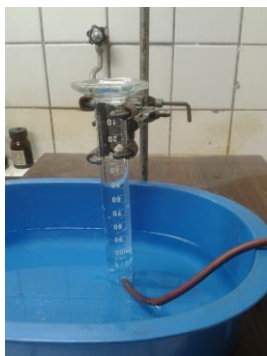
Obr. 19 Aparatura použitá ke kalibraci průtokoměrů
