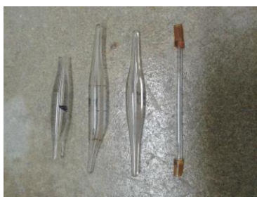
Obr. 5 Kapiláry použité u průtokoměru : seřazeny za sebou, zleva 1,2,3,4
