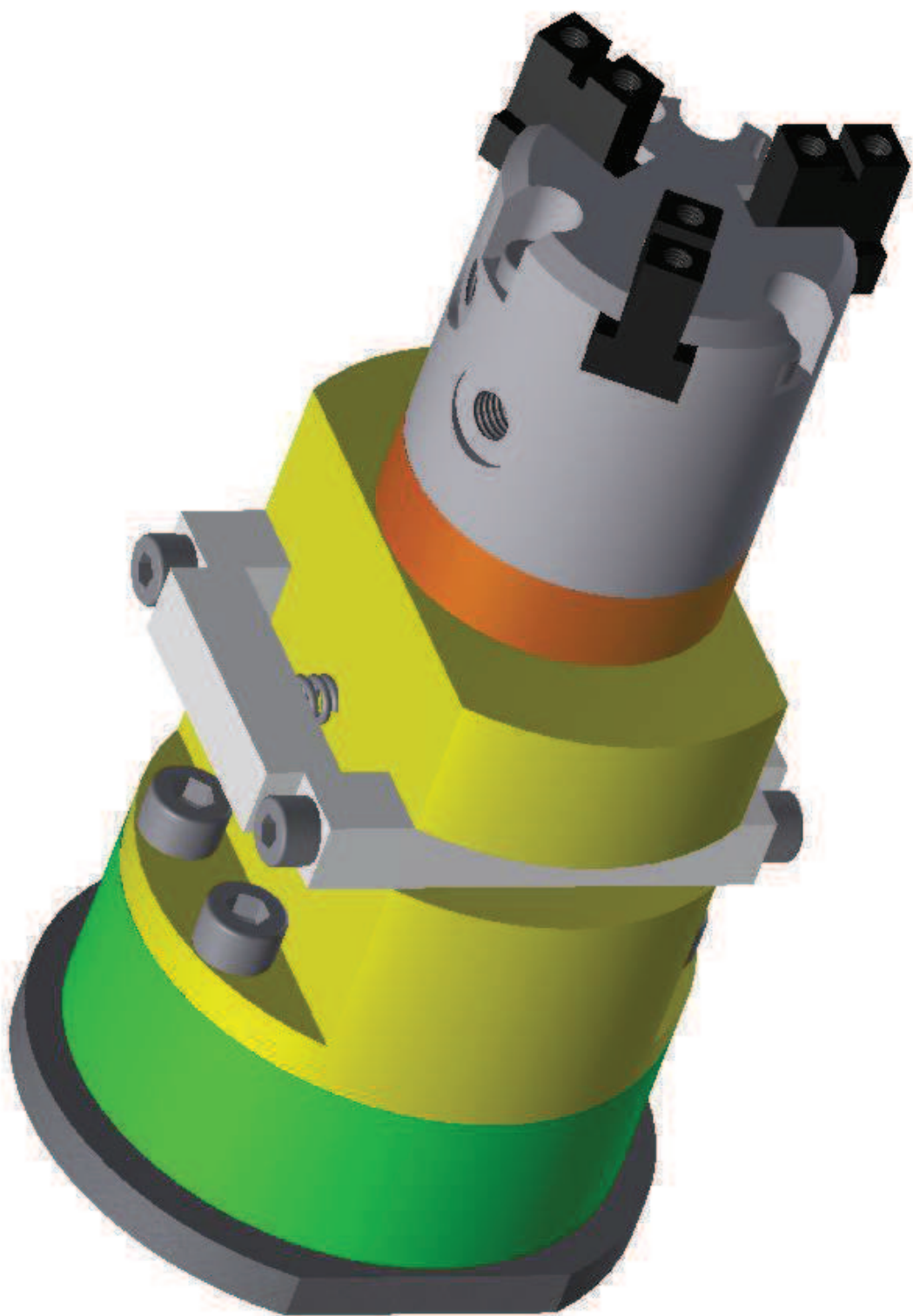
1 Vizualizace připojení čelistí MHS3-20D pomocí koncovky k rychloupínacímu mechanismu
