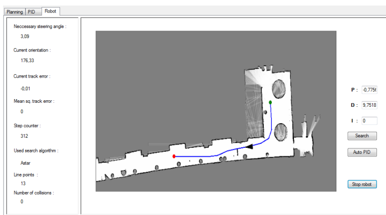
Obrázek A.6: Záložka robota s kompletním plánováním a regulace na trase mezi danými body.
