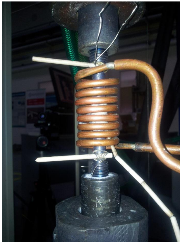
Obr. 44. Příprava zkušební vzorku pro provedení záznamu zkoušky při 800°C.
