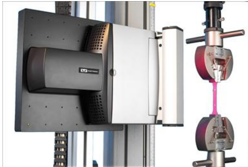
Obr. 15. Video extenzometr zabudovaný do stroje pro zkoušku tahem, [15].
