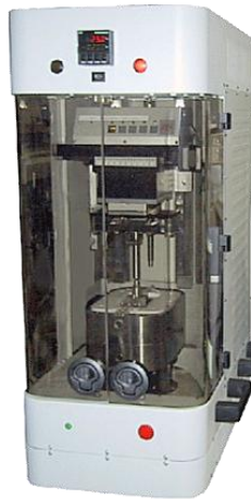
Obrázek 13 - 2 Tribotester UMT-3 značky BRUKER
