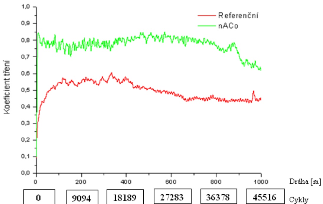
Graf 13.1 – 1 Porovnání koeficientů tření referenčního vzorku a testovaného vzorku s vrstvou nACo
